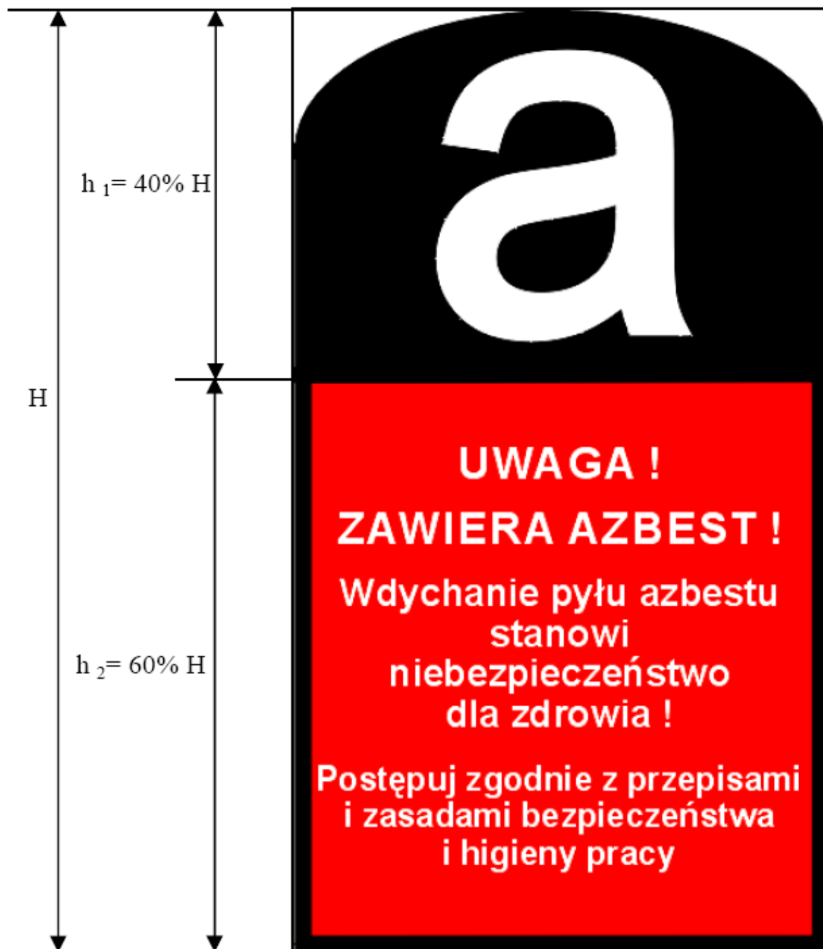
Rys.10. Wzór oznakowania wyrobów i odpadów zawierających azbest, wysokość znaku powinna wynosić co najmniej 5 cm a szerokość co najmniej 3 cm [ 27]
